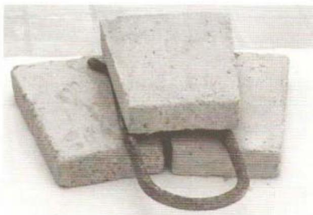
*Forma de colocar los anillos para la escalera entre los ladrillos de la pared de la chimenea*
